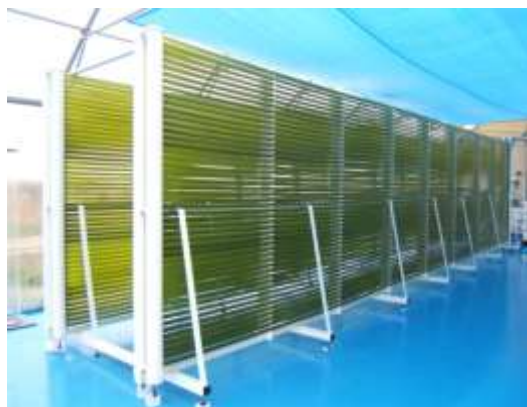
Figure 8 : Réacteur tubulaire BioFence. (Source : Greensea)
