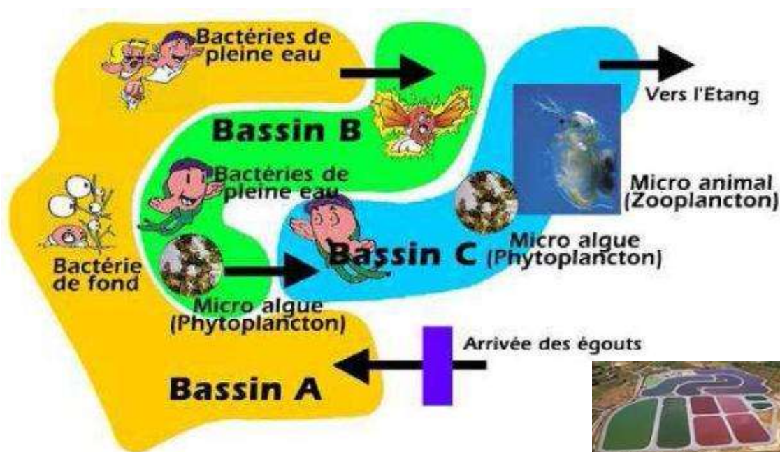
Figure 29 : Principe du lagunage de Mèze - Loupian. (Source : CEVA)
